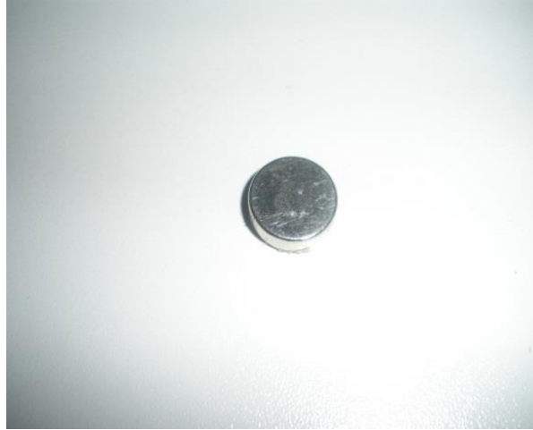
FIGURA 8 - Imã neodímio-ferro-boro ( \varnothing = 14 mm e L = 4 mm).
